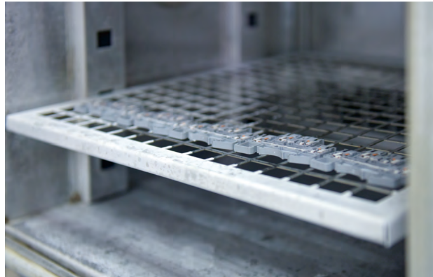
Циклические температурные испытания клемм на DIN-рейку
